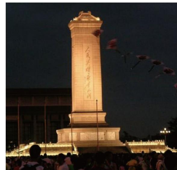
根据纪念碑建筑结构特征，灯光突出重点、表现层次，昼夜保持雄伟、庄严、肃穆的形象；结合纪念碑基座和汉白玉栏杆的结构特点，特别设计了双层特制灯具，顺着底沿设置自下而上的投光效果，使这个区域的层次更加分明，与碑身照明形成统一的照明效果。
