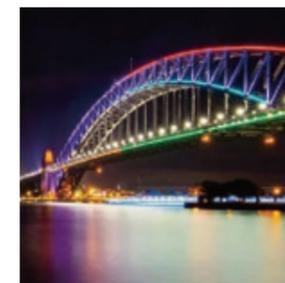
桥两边分别安装一排散出黄色光的投光灯，为行人、车辆提供照明，点缀整个桥面，使之光彩夺目；桥底和桥拱上设 LED 灯带，可变色的 LED 灯带，为大桥增添无限的魅力。
