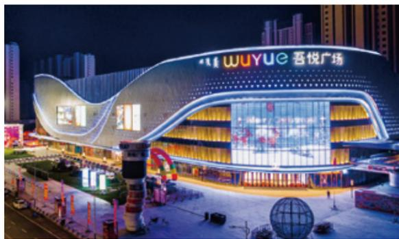
通过定制化，模块化的导光板设计与建筑结构相结合；其次是主要沿街面的飘带塑造；大面积铝板铺装采用立杆照明，次入口处大玻璃幕设置低密度屏，以此使得与主入口及整体的亮度均衡，不突兀却处处充满亮点。
